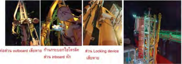
Tower gangway โครงสร้างบิด เสียรูป Hydraulic power unit เสียหาย
